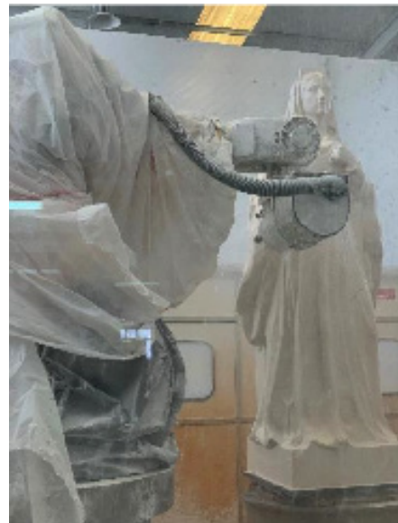
Figura 7. Proceso de mecanizado de la figura en Lozano Piedras Naturales. (a) Fase de desbaste general y (b) fase de afinamiento de la forma.
